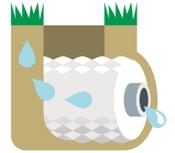
**Drenotube® è un sistema drenante geocomposito preassemblato alternativo al tradizionale pacchetto da comporre in opera formato da ghiaia+tubo+TNT.**
