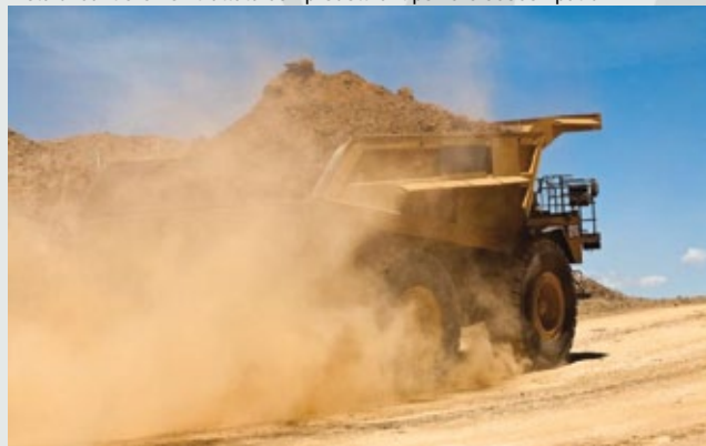
Pista di cantiere non trattata con prodotti antipolvere ecocompatibili
