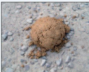
Figura 4 - La prova di coesione dell'inerte bagnato con il Soil Sement NF®
