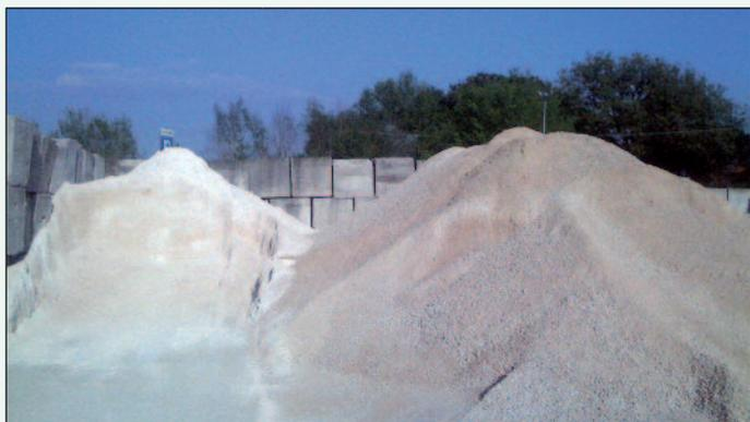
Figura 2 - I cumuli degli inerti utilizzati presso l'impianto (sabbia 0-4 mm e misto 0-20 mm)
