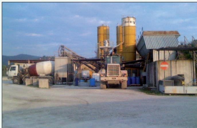
Figura 3 - L'impianto presso il quale sono state caricate le autobetoniere con 8 m<sup>3</sup> di inerte, 56 l di Soil Sement e 336 l di acqua
